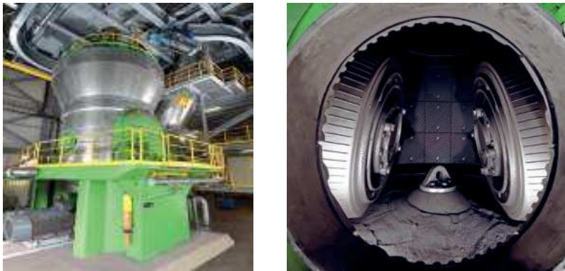
Валково-тарельчатая мельница для производства порошкообразной извести
