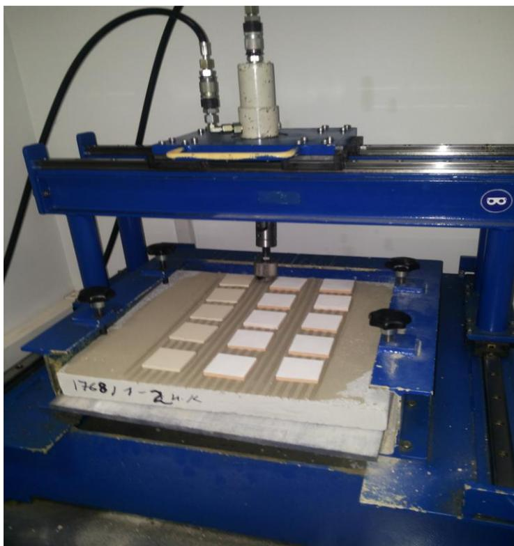
Рис. №1 Машина для определения прочности приклеивания Herion HB 850
